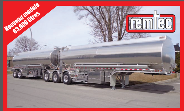
B-TRAIN POUR PÉTROLE REMTEC NEUF 2019 Capacité 63,000 litres, code TC-406, 6 compartiments. Nouveau modèle allégé, charge payante plus élevée.
