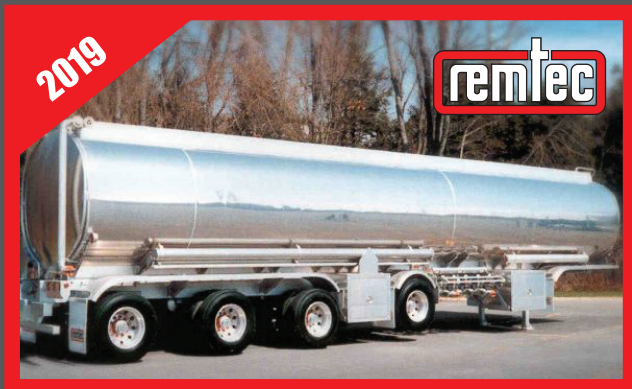
CITERNE POUR PÉTROLE REMTEC NEUVE 2019 Capacité 57,000 litres, code TC-406, 6 compartiments.
