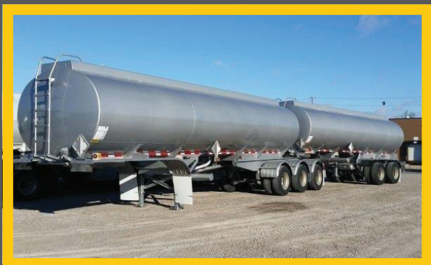
Unité : 10058 Marque : Beall Année : 2002 Modèle : R.T.A.C. Capacité : 62,000 litres Compt's : 5 Suspension : Pneumatique Roues : En aluminium 22,5 Inspections : S.A.A.Q. et B-620 inclus
