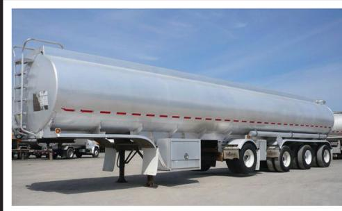
**REMTEC 2003, DOT-406, 57,000 LITRES** 5 compartiments, chargement par le fond, récupération de vapeur, suspension pneumatique, sorties individuelles-620 et inspection SAAQ.
