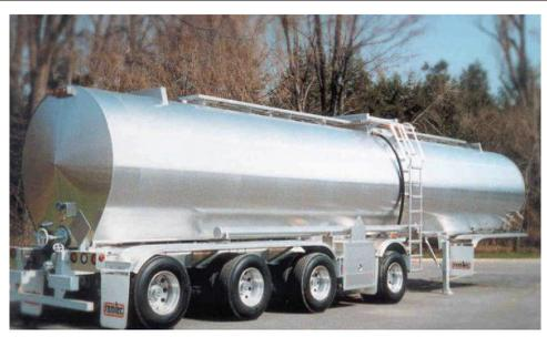
**CITERNE REMTEC NEUVE, 49,000 LITRES** 1 compartiment isolé, TC-406, complet avec chargement par le fond, Scully, récupération de vapeur, pneus Michelin, roues d'aluminium. Disponible fin août.
