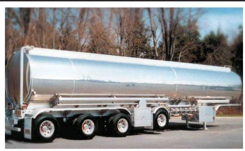
**CITERNE NEUVE REMTEC 2011, 57,000 LITRES** 6 compartiments, TC-406, chargement par le fond, récupération de vapeur, suspension pneumatique, roues d'aluminium. Disponible fin septembre.
